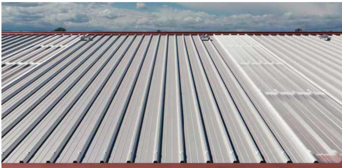
Panel sándwich de doble revestimiento metálico, para cubiertas con pendiente no inferior al 7%, aislado en poliuretano, con lámina exterior perfilada de 5 greclas para aumentar la resistencia a las cargas estáticas y dinámicas. La fijación es a vista con grapas metálicas con guarnición. Se usa también para recubrir fachadas.
