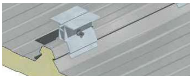
Detalle enganche de accesorios para cubiertas
