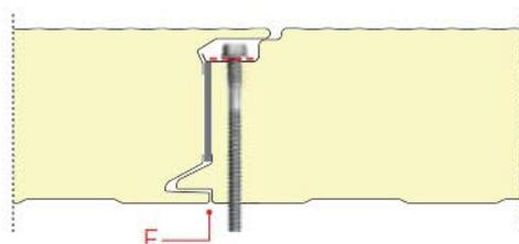
Isopan recomienda, durante la fase de montaje, usar adecuada pieza de fijación de acero para la distribución de los esfuerzos de fijación y la posición tiene que garantizar la resistencia al estrés de la fijación sobre el panel, incluso los esfuerzos de depresión.
